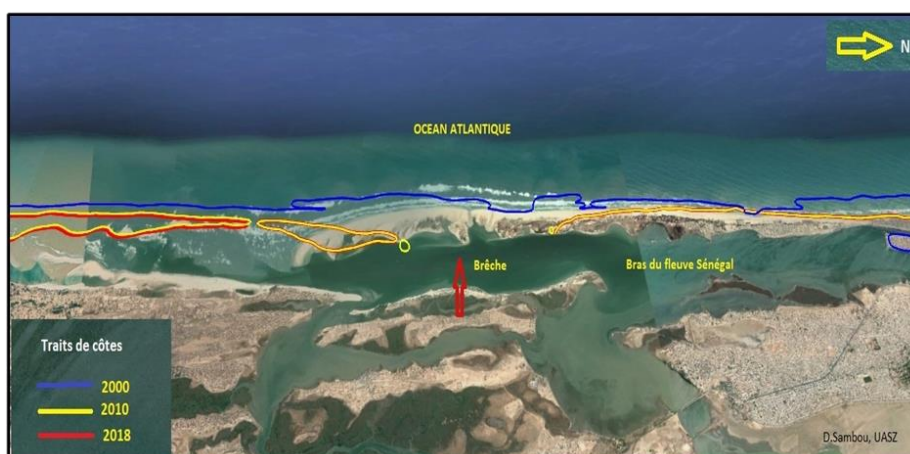
Figure 3: Secteur B. Déplacement de la ligne de côte de 2000 à 2018. De Santhiaba, en passant par la plage d'hydrobase jusqu'au sud de la brèche
